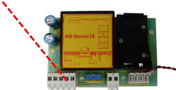
**OPERAZIONE D** - Estrarre e reinserire il morsetto della elettrovalvola ameno 5 volte.
